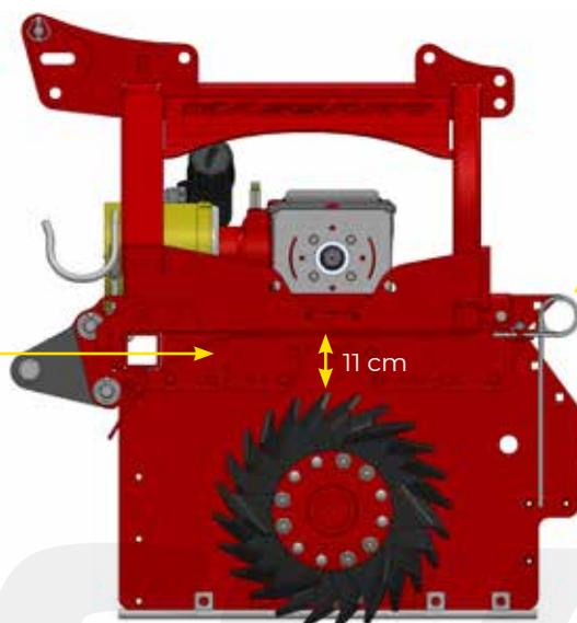
La griglia di selezione con molle indipendenti **REGOLABILE** consente di lavorare anche su terreni umidi, separando il materiale grossolano da quello finemente lavorato: i sassi vengono interrati e il terreno raffinato ricopre la superficie, creando un letto ottimale per la semina.
